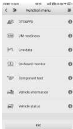
Рисунок 7-15. Пример диагностического меню OBD II
