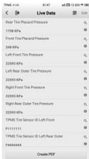
Рисунок 4-15. Пример окна, содержащего оперативные данные
